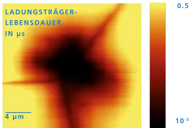
3 Lebensdauerermessung um ein Nickelpräzipitat an einem Korngrenzen-Triplepunkt mit Mikro-Photolumineszenz.
